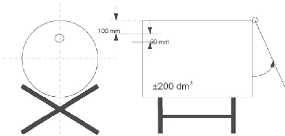
d) Sur un support métallique de 200 mm × 200 mm, placer une bougie à la cire de paraffine mesurant entre 20 et 40 mm de diamètre et 100 mm de haut. Remplacer la bougie quand sa hauteur descend au-dessous de 80 mm. La flamme de la bougie est protégée de l'aérosol par un déflecteur de 150 mm de large sur 200 mm de haut, incliné à 45° à partir d'une hauteur de 150 mm au-dessus de l'embase du déflecteur (figure 3.2.2).
