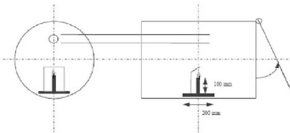
f) Le fût est posé à même le sol ou sur un support, dans un endroit où la température est comprise entre 15 et 25 °C. L'aérosol soumis à l'essai est vaporisé à l'intérieur du fût, d'une contenance approximative de 200 dm<sup>3</sup>, dans lequel est placée la source d'inflammation.
