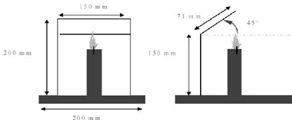
e) La bougie placée sur le support métallique doit être située à mi-distance entre les deux extrémités du fût (figure 3.2.3).
